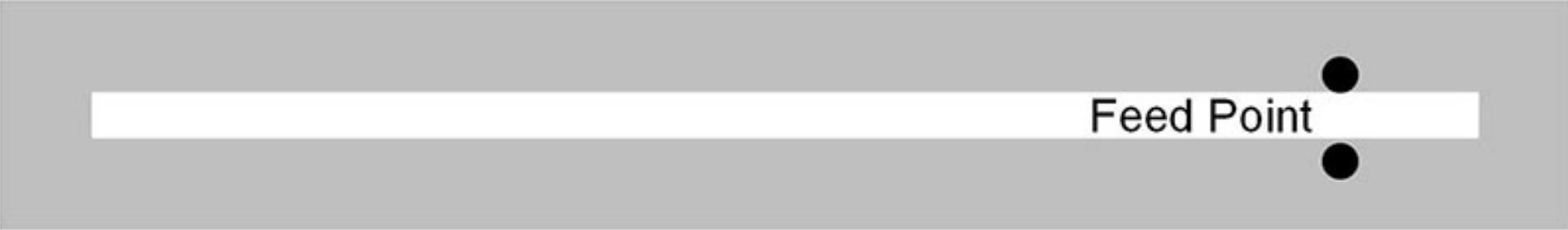
HALF WAVELENGTH SLOT ANTENNA
